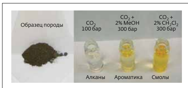
Рис.6. Ступенчатая экстракция нефтяных пород с помощью СФЭ с соразтворителями
