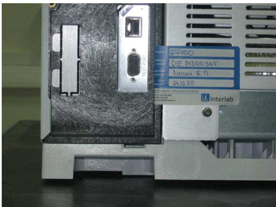
Рисунок 2. Место пломбирования для защиты от несанкционированного доступа
