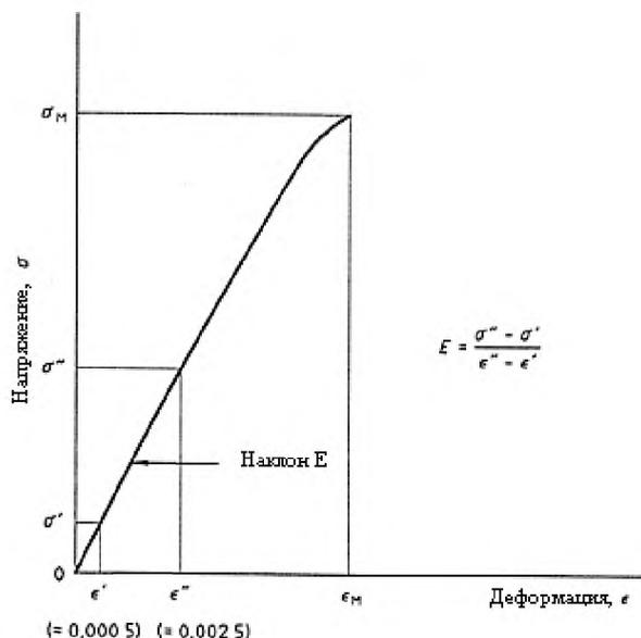
Рисунок 2 – Диаграмма напряжение-деформация
