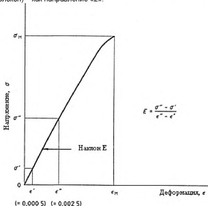
Рисунок 1 – Кривая напряжение – деформация
