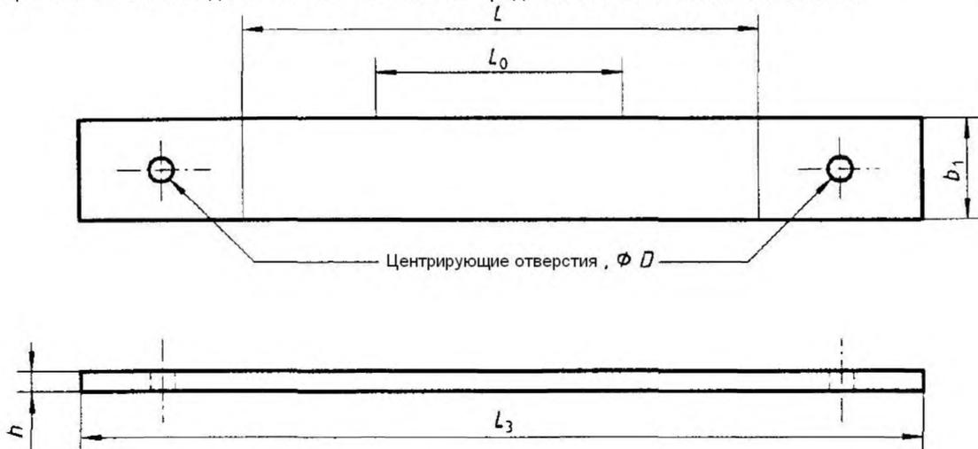
$L$  – исходное расстояние между захватами;  $L_0$  – измерительная база;  $L_3$  – общая длина;  $h$  – толщина;  $b_1$  – ширина;  $D$  – диаметр центрирующих отверстий для штифтов
