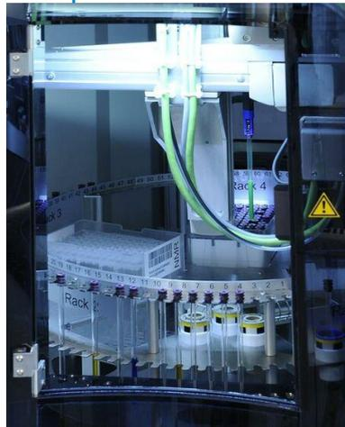
Система автоматизации на 24 образца, с произвольным доступом, подходит почти всем экранированным магнитам Bruker со стандартным отверстием
