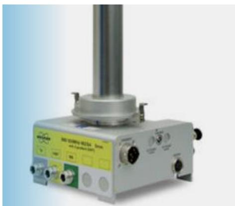
DiffBB - это широкополосный градиентный зонд для диффузионных применений в стандартном и широкополосном магнитах, оптимизированный для очень сильных градиентных импульсов, создаваемых для образцов в 5 мм пробирках. Его широкополосные возможности поддерживают 1H и 19F, а диапазон широкополосных ядер X составляет от 31P до 15N, а также канал блокировки 2H.
