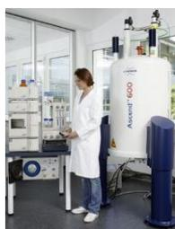
Использование системы Bruker ЖХ-ТФЭ-ЯМР позволяет добиться значительного увеличения соотношения сигнал-шум в ЯМР-спектрах благодаря концентрированию образца. Это делает ее идеальной для полного структурного анализа с использованием сложных инверсных экспериментов или при исследовании примесей, содержащихся в смесях в низкой концентрации. Более того, полностью дейтерированный элюент позволяет проводить измерение спектров ЯМР в стандартных условиях.
