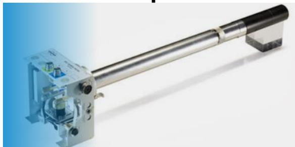
Микроизображающий зонд Micro 5 был разработан для применений со стандартными магнитами с внутренним диаметром (внутренний диаметр 52 мм) для исследования небольших объектов диаметром от <1 мм до макс. 10 мм.
