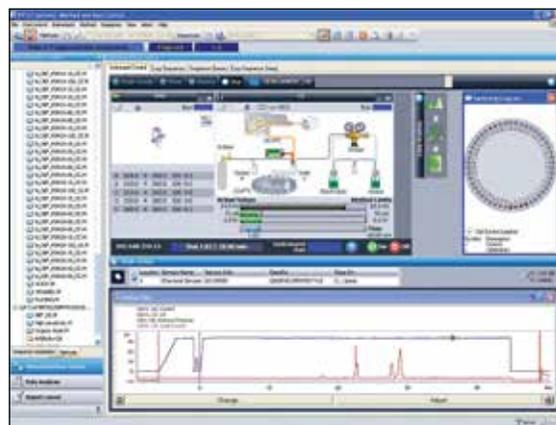
Стандартное ПО управления прибором КЭ Agilent 7100 и анализа данных можно расширить и включить средство управления одноквадрупольной системой МС серии Agilent 6000.
