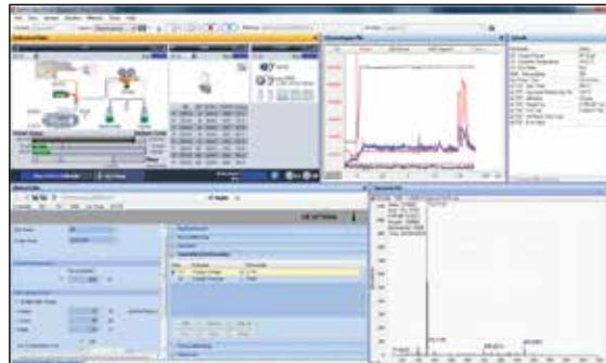
Версия B.05.01 и более поздние версии включают средство управления прибором КЭ Agilent 7100 в дополнение к стандартному средству управления прибором для ВЭЖХ серии 1200 Infinity для всех времяпролетных, квадрупольно-времяпролетных и трехквадрупольных приборов МС серии Agilent 6000.
