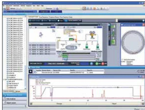
Стандартное ПО управления прибором КЭ Agilent 7100 и анализа данных можно расширить и включить средство управления одноквадрупольной системой МС серии Agilent 6000.
